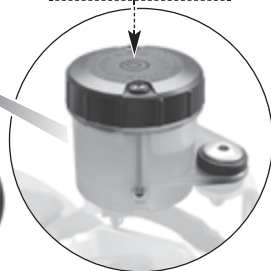
Réservoir de frein AV.
