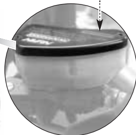
Réservoir de frein AV.
